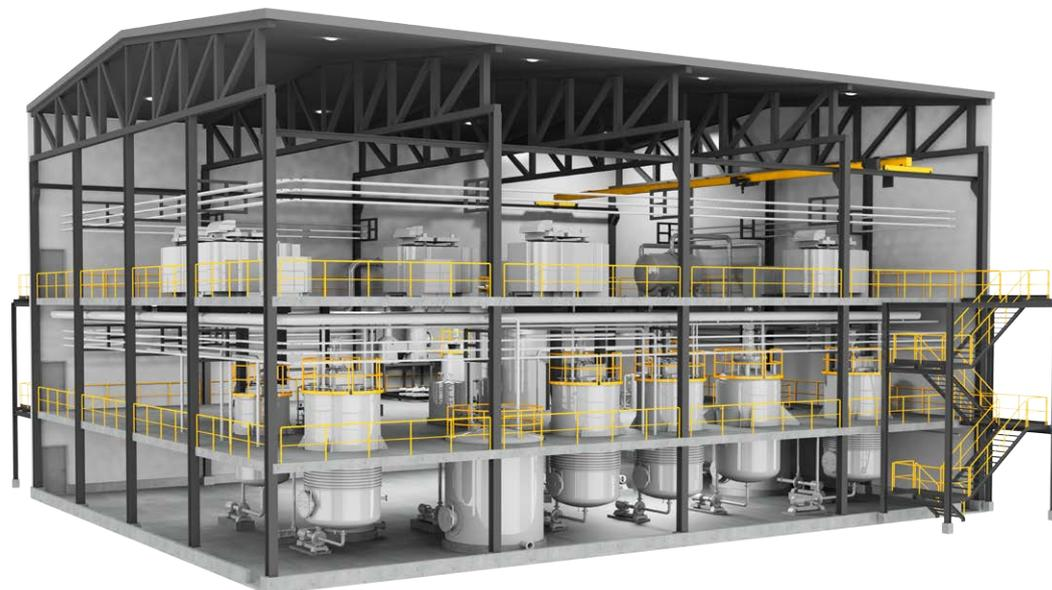
美卓湿法冶金贵金属工艺是贵金属加工技术几十年经验和不断发展的结果，可实现更高的直接回收率和低尾矿量。经济高效的模块化方法包括浸出、过滤和析出步骤，且可适用于各种应用，包括处理阳极泥或其他含有贵金属的残留物。
