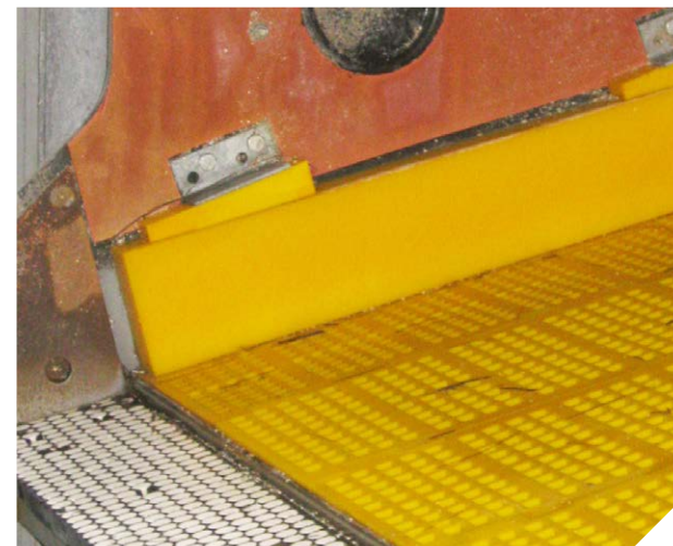
用于CVB或TS振动筛的平顶面聚氨酯侧壁护板
