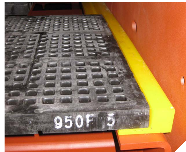
LS-S-290-500边筛板搭配边角条完成正确的安装
