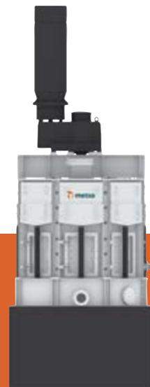
介质搅拌式磨机(SMD)是一款流化立式搅拌磨机，最适用于生产细粉和超细磨矿产品。SMD利用叶轮的旋转动能，使磨矿腔室中的介质和料浆混合物产生高能运动，进而产生颗粒间的剪切和挤压力，形成细磨理想磨矿过程。立式布置的优点在于：完全利用磨机本体支撑动力和传动系统，使设备占地面积更小、基础更加简单。
